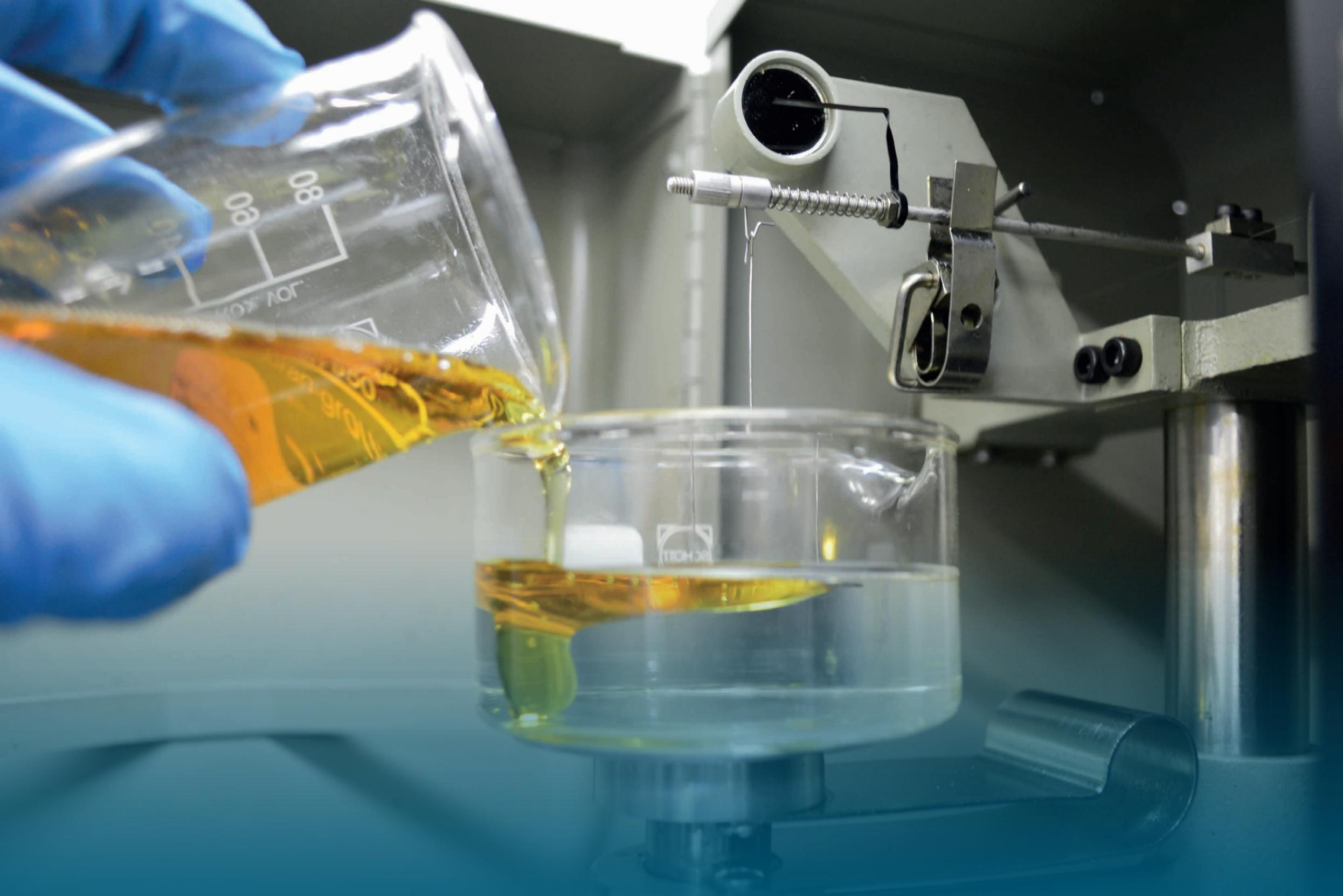
Diagnósticamos la condición del papel aislante por medio del **análisis dieléctrico y fisicoquímico (ADFQ)**, que incluye: rigidez dieléctrica, contenido de agua, número ácido, densidad relativa, tensión interfacial y color.
