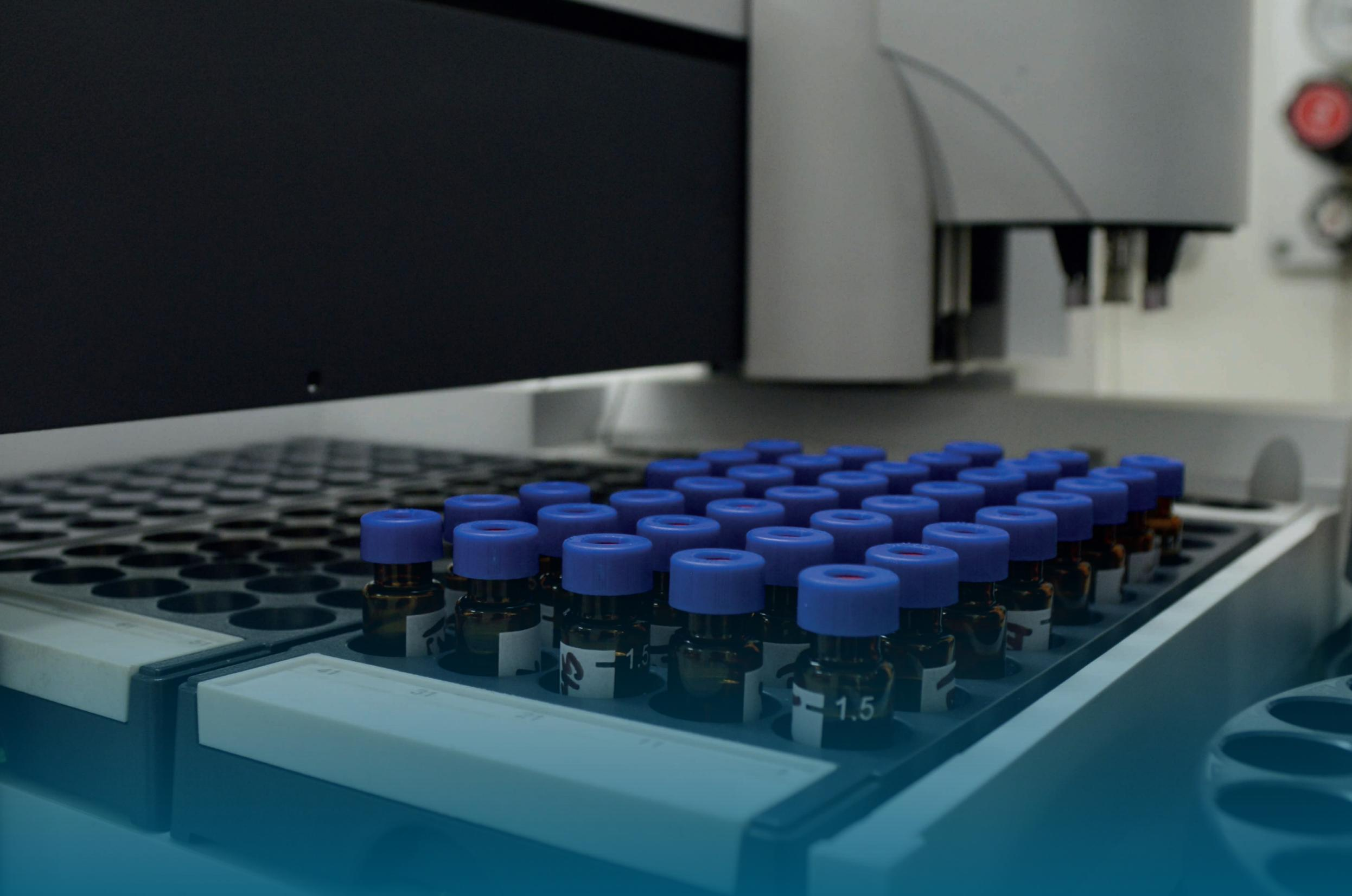
Realizamos el análisis de contenido de bifenilos policlorados (PCB´s), mediante cromatografía de gases, para determinar su concentración en el aceite de transformadores **ASTM D-4059**.
