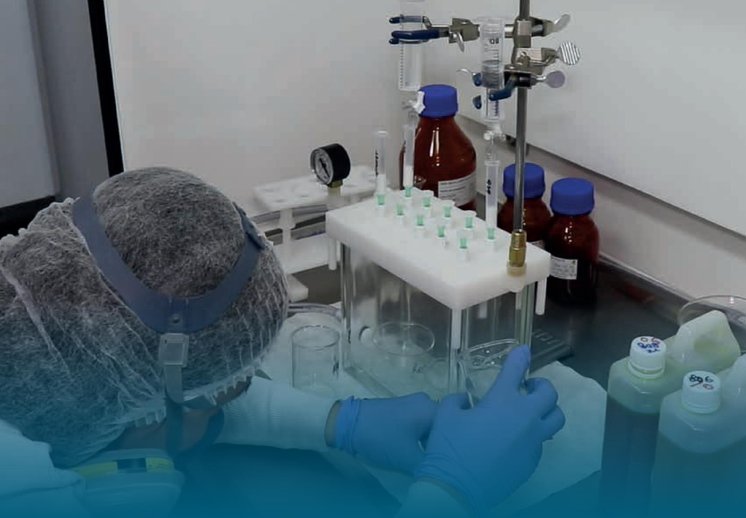
Por medio de un ensayo especializado, realizamos la **determinación de contenido de inhibidores artificiales**, Diterbutil para cresol (DBPC) y 2,6 Diterbutil fenol (DBP) Norma (ASTM D4768 – 11 (Reapproved 2019)).
