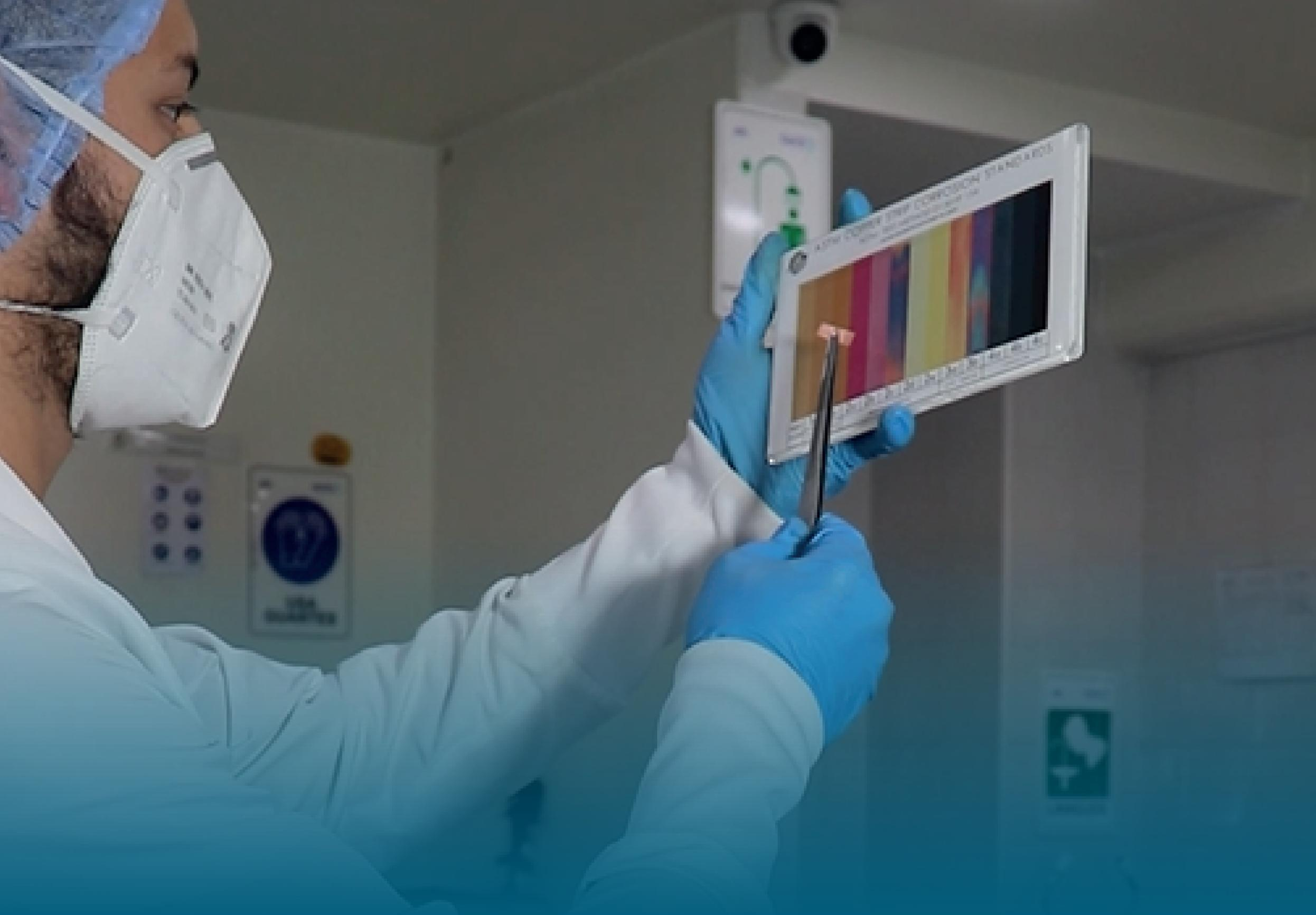
Aplicamos pruebas especiales al aceite dieléctrico, como: determinación de **azufre corrosivo (ASTM D1275-15)**, grado de polimerización y determinación del factor de disipación o **factor de potencia (ASTM D924 – 15)**.
