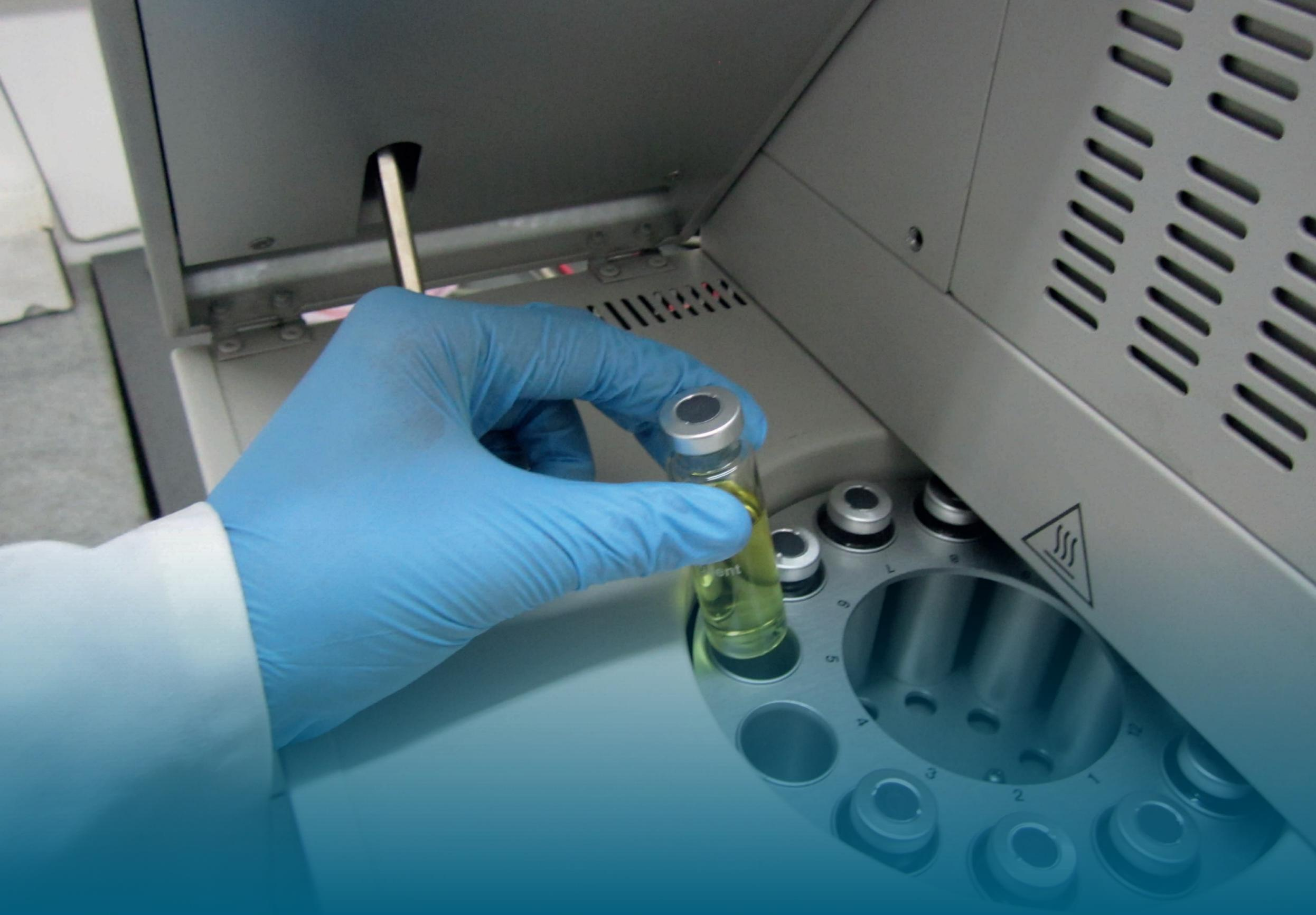
Determinamos la presencia de gases que pueden indicar posibles fallas de tipo térmico o eléctrico; por medio de **cromatografía de gases ASTM D3612-02 (2017) (MÉTODO C)**.
